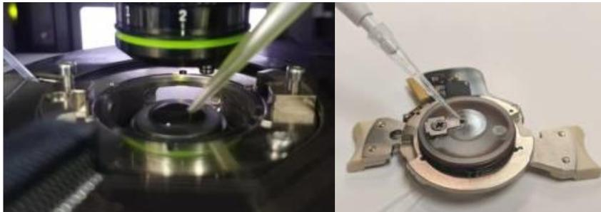
3. 将 Scanner 推回初始位置，并将其右侧的黑色把手拉下，向右旋转物镜的（聚焦矫正环），将其对应在 2.0 的位置，关上隔音罩；
