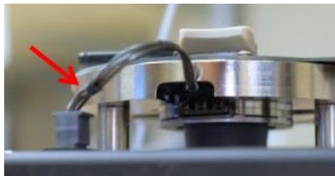
2. 导电样品的制备。选择导电样品台，在上面涂上少量导电银浆，然后将固定好样品的普通样品台放置于导电样品台上，并在样品与导电样品台之间涂上少量导电银浆，待导电银浆固化后，可以万用表确认样品和引线是否接通导电；
