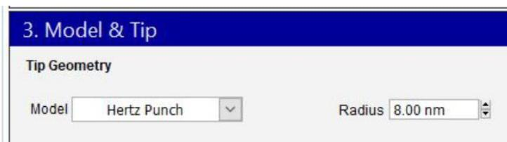
13. 建议用户在测量未知样品前先准备一个已知杨氏模量的标样，且其杨氏模量应与未知样品近似。首先使 AMFM 技术对标样进行扫描，在扫描的时候不断调整 Tip Radius，知道 Young's Modulus 窗口的数值和标样的已知杨氏模量相等，将此 Radius 值记下。换上待测的未知样品，使用相同的探针，在 AMFM 模式下扫图，输入刚才记下的 Radius 值，此时 Young's Modulus 窗口反应的应该就是样品的真实力学特性了。
