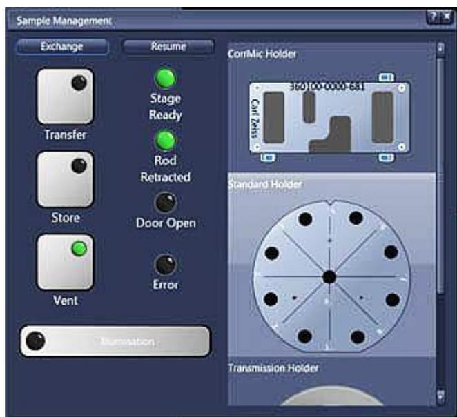
图 5 通过软件进行真空状态检查示意图
