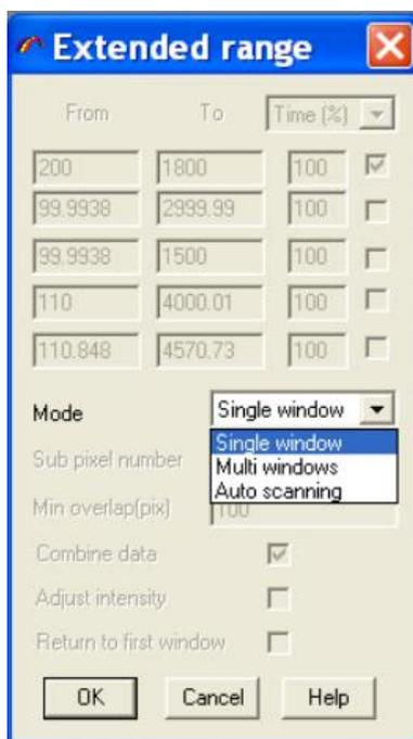
在连续采谱时可选择自动连接谱图，如果信号背景变化较大导致连接失真，可在 Acquisition 中设置 Options。将 Intensity correct 设为 off(左下图)。再将 Adjust intensity 打钩后可得到较好的自动接谱。常规使用时 Intensity correct 推荐使用 ICS HORIBA (右下图)。
