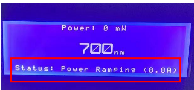
图 3 激光器加载过程
