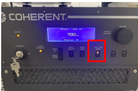
图 4 激光 shutter 开关
