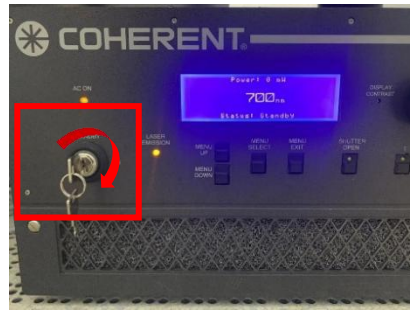
图 2 打开激光器前面开关
