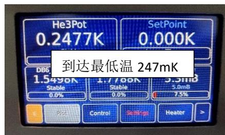
图 15 氦 3 插杆极低温示意
