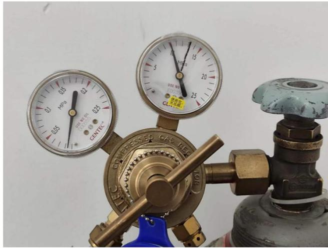
图 10 当 VTI 腔体真空计示数约为 0.15bar 时，减压阀示数如图所示。
