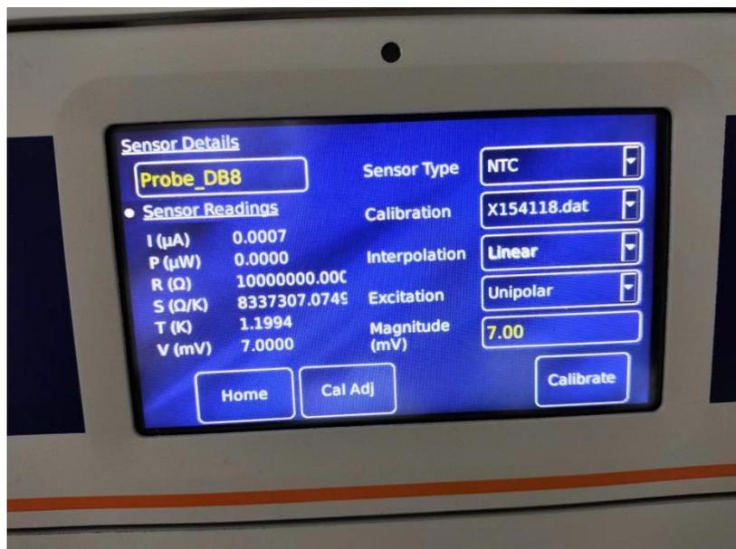
Calibration 选择相应的校准曲线：电学杆选择 X154118. dat，傅德颐组旋转杆选择 2DRot\*\*\*FuLab. Dat 文件。
