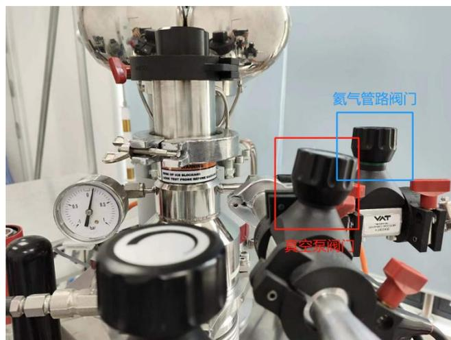
图 9 高纯氦气管路阀门示意图
