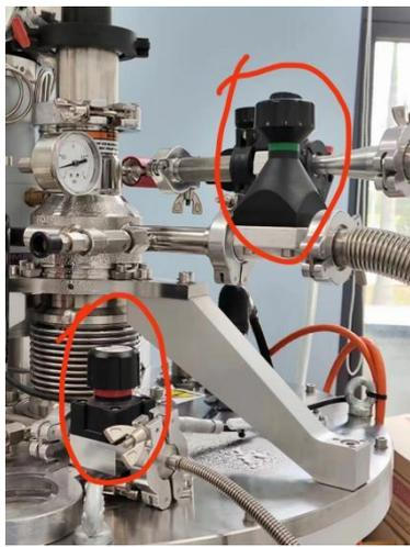
图 3 VTI 腔体与氦气循环回路连接管路
