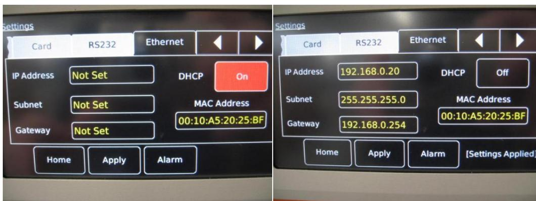
3. 启动 RM 软件。选择 TCP/IP，Host=192.168.0.20，勾选 Telnet，TCP 端口#23，按“确定”
