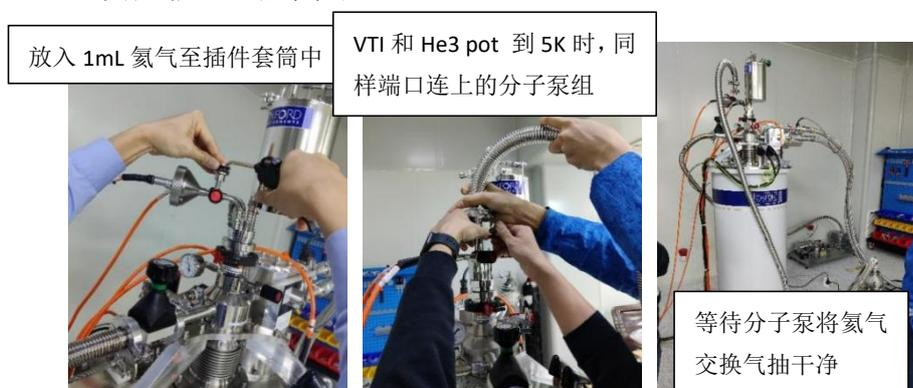
图 14 氦 3 插杆操作流程
