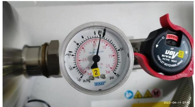
图 7 氦气循环回路压力表
