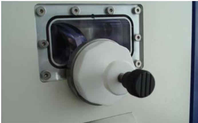
4. 样品杆推到底后，样品台边缘对齐。逆时针旋转样品杆黑色旋钮（旋转 6 圈左右），水平轻轻将样品杆拉出，Rod Retracted 常亮状态后再点击 Store。（Rod Retracted 闪烁无法关闭预抽室的挡板，样品杆未拉到指定位置）
