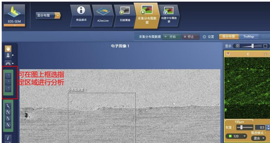
6. 进入构建分布图数据页面→点击“确认元素”，对所测元素进行删减处理，Auto ID 为自动识别出峰位置元素类型→点击“分析器”重新进入面分布图页面；
