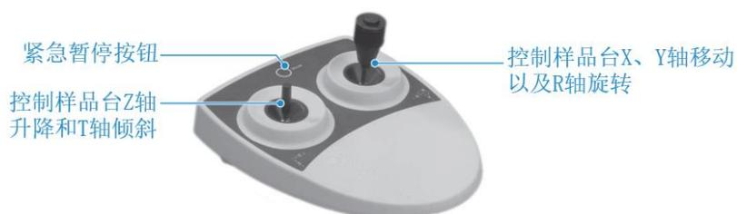
3. 通过右边的操作杆将样品移动到电子束正中心位置（即右下角 Stage Topview 十字中心位置）→再通过左边的操作杆升到与物镜极靴底部大概一个拇指的距离；（移动样品台注意样品和物镜极靴的距离，不要撞上去）;
